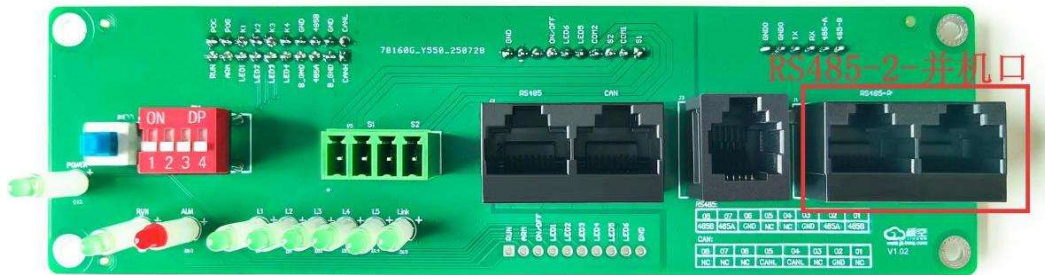
Połączenie kabla RS485 z płytą interfejsu (gniazda RS485-2)
